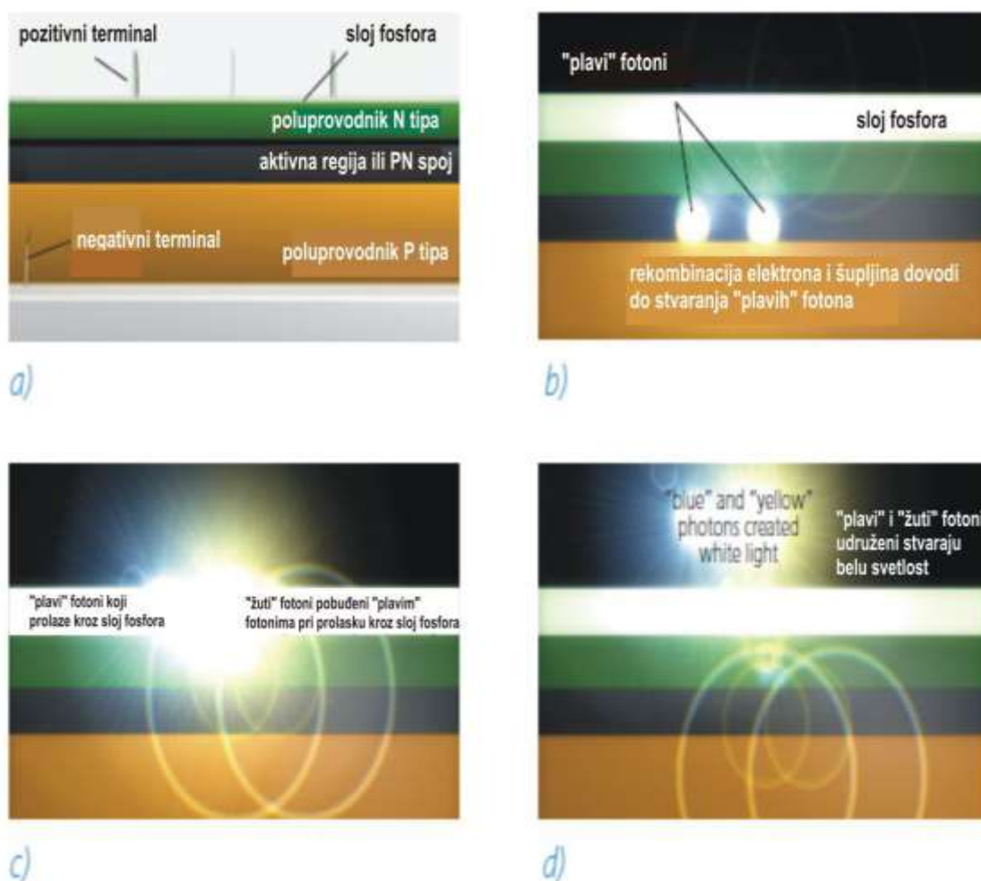
Slika 19. Pojava optičkog zračenja na PN spoju [9]
